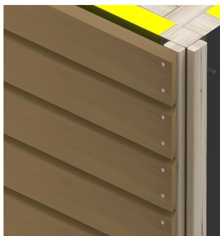
Rhombus-Profile \geq 80 mit 2 Schrauben oder Nägeln befestigen.
