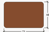
Unterkonstruktion Kebony Character 48 x 73 mm
